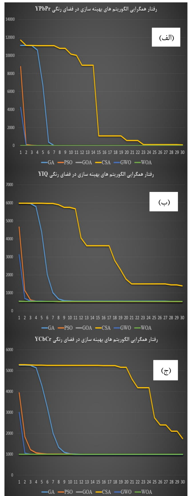
شکل ۹: نمونه‌ای رفتار همگرایی الگوریتم‌های فرا-ابتکاری در فضاهای رنگی به‌کار گرفته شده در مطالعه. (الف): رفتار همگرایی در کانال Pr فضای رنگی YPbPr، (ب): رفتار همگرایی در کانال I فضای رنگی YIQ، (ج): رفتار همگرایی در کانال Cr فضای رنگی YCbCr.
