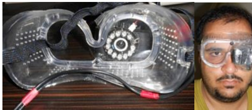
شکل ۱: نمای عینک مجهز به دوربین مادون قرمز (IR-EMD)
