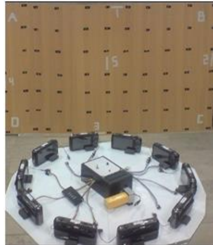
شکل ۴: تصویربرداری از میدان آزمون برای تعیین پارامترهای توجیه داخلی و توجیه نسبی بین لنزها.
