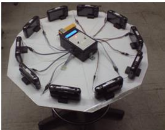
شکل ۳: سیستم مدل‌ساز استریو پانوراما.
