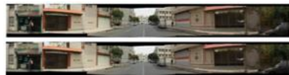
شکل ۶: دو استریو پانورامای تولید شده با استفاده از اتصال به روش تناظریابی (بالا) و روش استفاده از اطلاعات کالیبراسیون (پایین).
