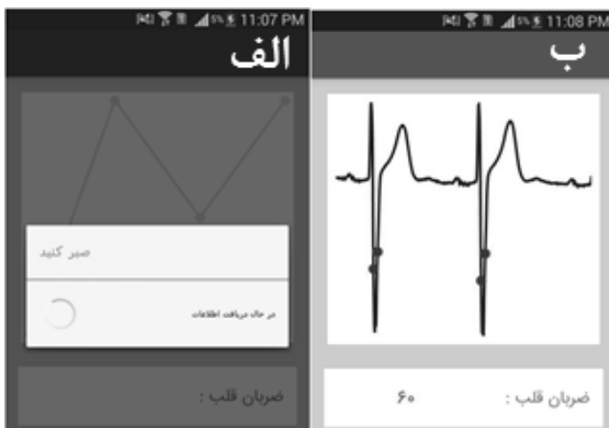
شکل ۷: اپلیکیشن طراحی شده: الف- دریافت سیگنال ب- نمایش خروجی ها، محل تقاطع ها و تعیین ضربان قلب
